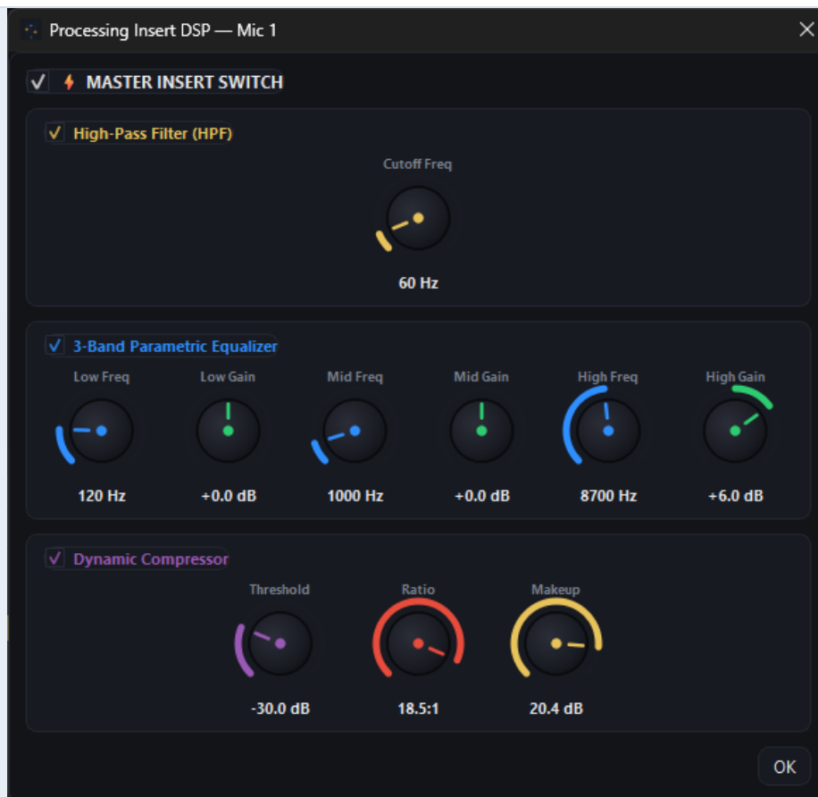
Diálogo de Procesado DSP: encoders rotativos iluminados para HPF, EQ de 3 bandas y compresor, en vivo sobre el canal "Mic 1".
